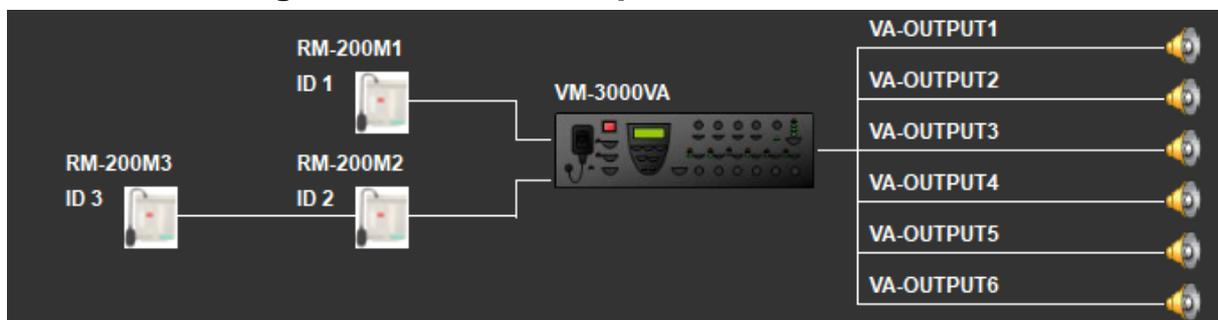
Werden nur Sprechstellen verwendet, empfehlen wir die AL-Sprechstellen auf den RM-Link 1 zu konfigurieren und die normalen Sprechstellen auf den RM-Link 2 zu stellen. Das vereinfacht die Verkabelung der Sprechstellen auf dem Interface.
