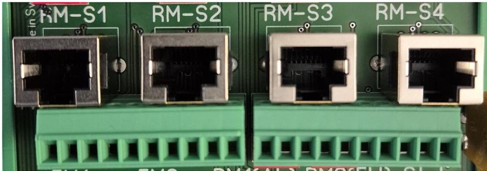
Die mittleren 4 RJ-45 Anschlüsse mit den Bezeichnungen RM-S1 bis RM-S4 dienen dem Anschluss aller Sprechstellen ohne Alarmfunktionen und führen zum Ausgang RM2(FW), der in der Regel beim RM-Link 2 am VM-3000 führt. Wird dort eine RM-200AL angeschlossen, hat die Alarmtaste keine Funktion. Eine Feuerwehrrstation mit RJ-45 Anschluss kann dort aber angeschlossen werden.
