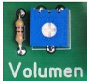
Das Line-Out Signal lässt sich mittels Potentiometer auf dem Print auf das anzuschliessende Gerät anpassen. Standard ist es auf mittleren Pegelausgang eingestellt.
